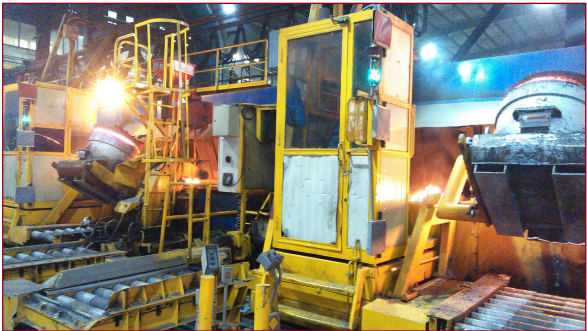
图3：系统3000增强版：正在并行浇铸欣特卡斯特蠕墨铸铁气缸体。
