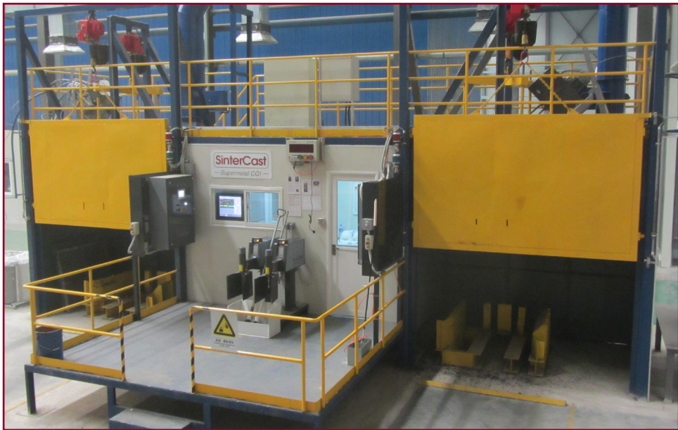
图1：系统3000增强版原铁水预处理站和校正处理站。
