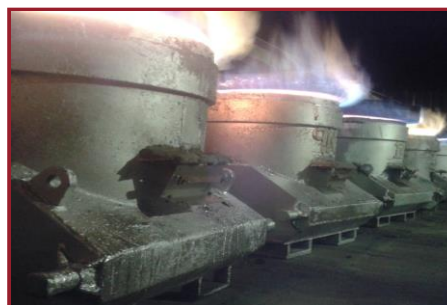
RFID-skänktaggarna fästa vid varje skänk
