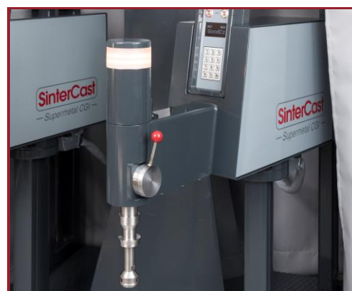
Ombyggd SAM med förbättrad termoelementhållare
