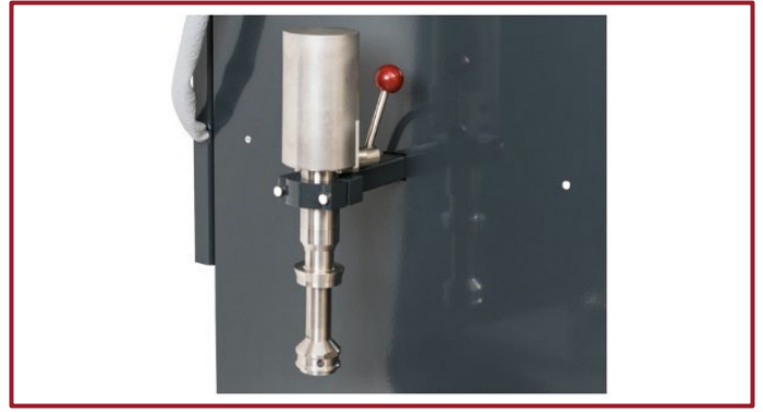
그림 3: 개선된 열전대 홀더 및 재설계되어진 SAM
