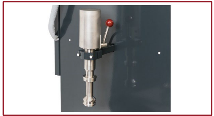
Figura 3: SAM reprojetoado com suporte termopar aprimorado
