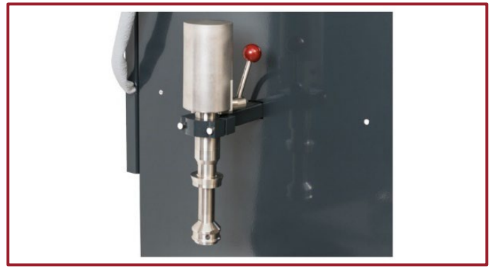
그림 3: 개선된 열전대 홀더 및 재설계되어진 SAM
