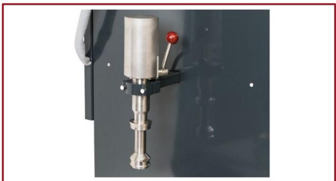
图 3: 重新设计的取样模块改进了热电偶支架
