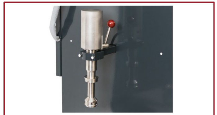
그림 3: 개선된 열전대 홀더 및 재설계되어진 SAM
